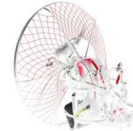
Châssis carbone haute performance (pré-imprégné - autoclave)
